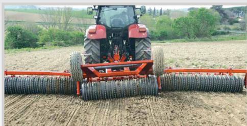
Le système SPRINGFLEX assure un suivi du terrain dans toutes les situations dénivelées et répartit uniformément le poids sur l'ensemble des blocs fonte grâce au ressort de liaison.
