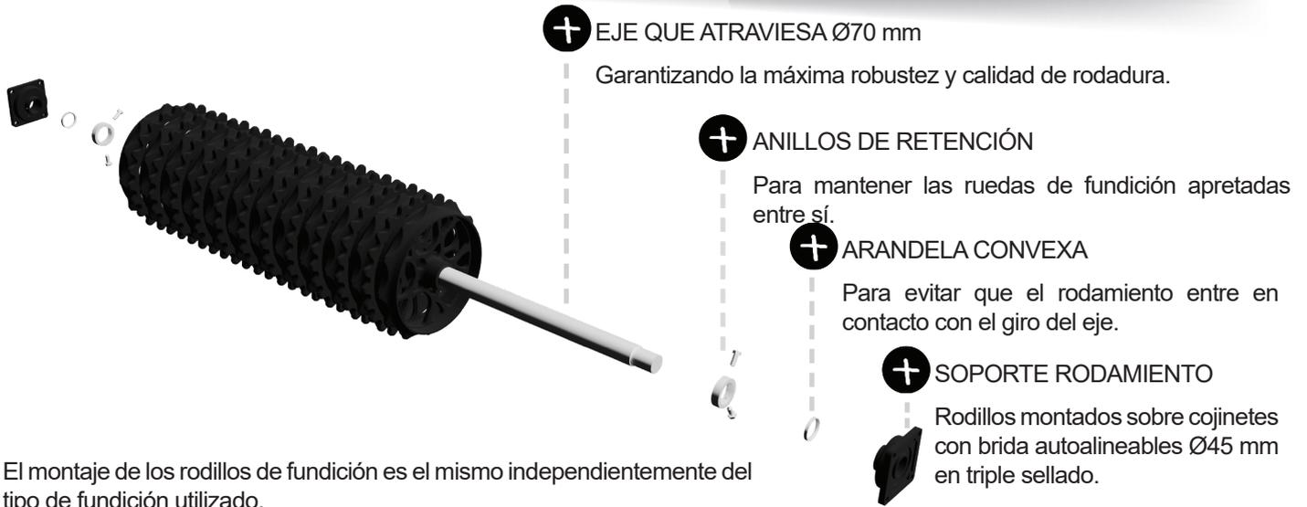
El montaje de los rodillos de fundición es el mismo independientemente del tipo de fundición utilizado.
